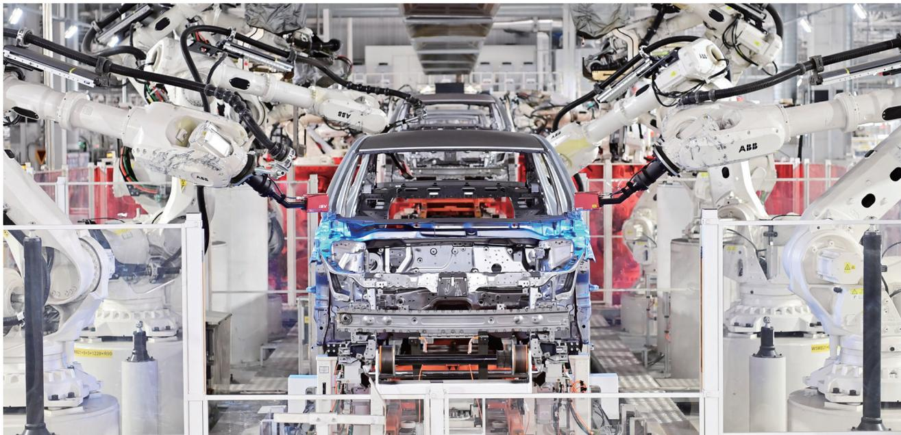
中国一汽红旗制造中心繁荣厂区焊装车间机器人自动焊接生产线
